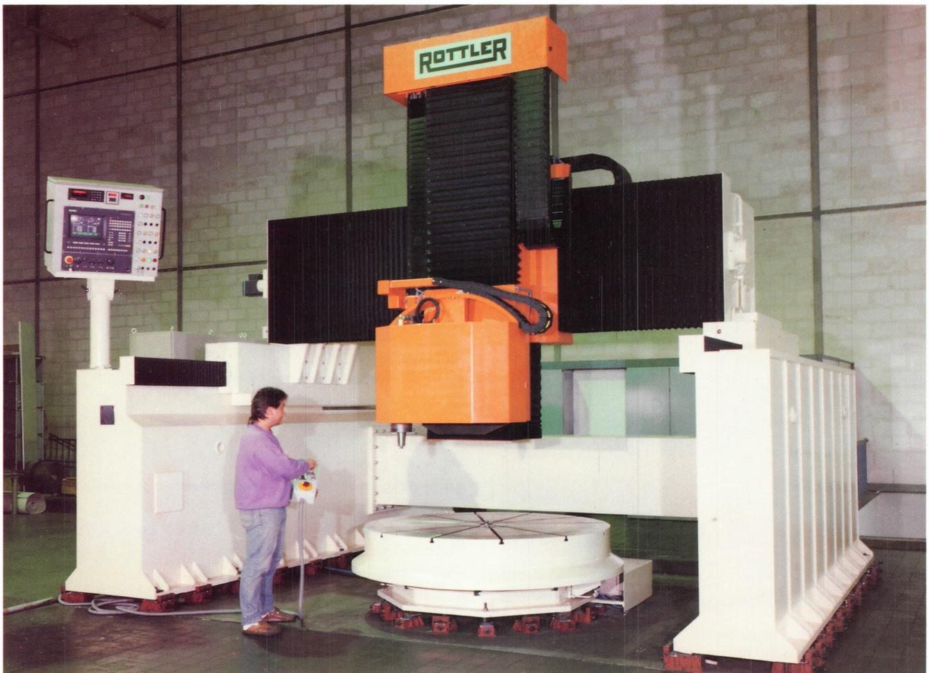
Portalschleifmaschine mit Planscheiben-Drehtisch zur Schleifbearbeitung von konkaven und konvexen Großlinsen für Spiegelteleskope sowie zur Komplettbearbeitung großer Glaskeramik-Hohlzylinder einschließlich zirkulares Bohrungsschleifen.
